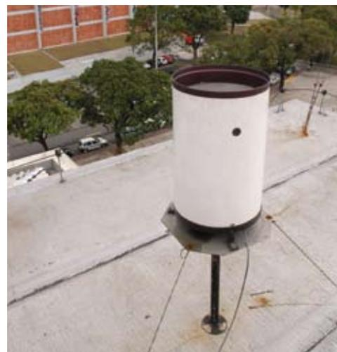
deslizamentos nas encostas. Por isso, foram instalados pluviômetros automáticos nas bases dos maciços montanhosos do município, locais onde os acidentes geotécnicos ocorrem com mais frequência.
